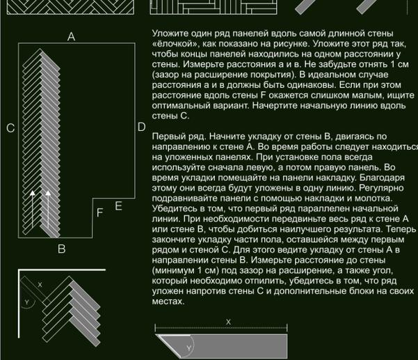
Уложите один ряд панелей вдоль самой длинной стены «елочкой», как показано на рисунке. Уложите этот ряд так, чтобы концы панелей находились на одном расстоянии у стены. Измерьте расстояния а и в. Не забудьте отнять 1 см (зазор на расширение покрытия). В идеальном случае расстояния а и в должны быть одинаковы. Если при этом расстояние вдоль стены F окажется слишком малым, ищите оптимальный вариант. Начертите начальную линию вдоль стены С.
